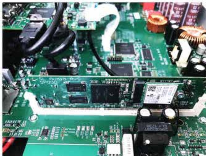
這塊直立的線路板上有兩個主要元件，一個是Intel AC8260模組，負責Wi-Fi與藍牙4.2無線傳輸；另一個是32位元的APM Cortex-A9處理器。
