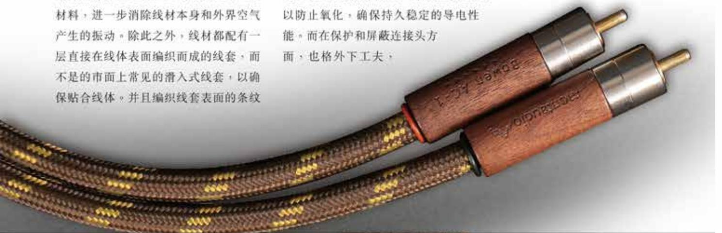
色与棕色搭配的外观来看，是采用了高纯度99.9997%线形结晶无氧铜作为导体材料，由三组导体构成平衡结构，分别由2组19芯直径0.15mm的导体和1组7芯直径0.25mm的导体组成。导体绝缘材料采用高品质聚乙烯绝缘，由全铜箔和无氧铜编织材料进行屏蔽。线材的连接头由纯紫铜制成，表面作24K无镍镀金，并且由天然胡桃木作装饰。
